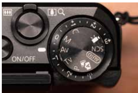
図1 キヤノン PowerShot G7X Mark II の露出補正ダイヤル（-2/3 段補正の状態）
